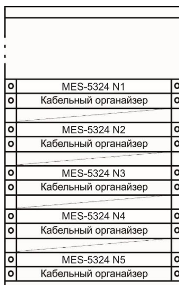
Рисунок 44 — Размещение коммутаторов MES5324 в стойке
