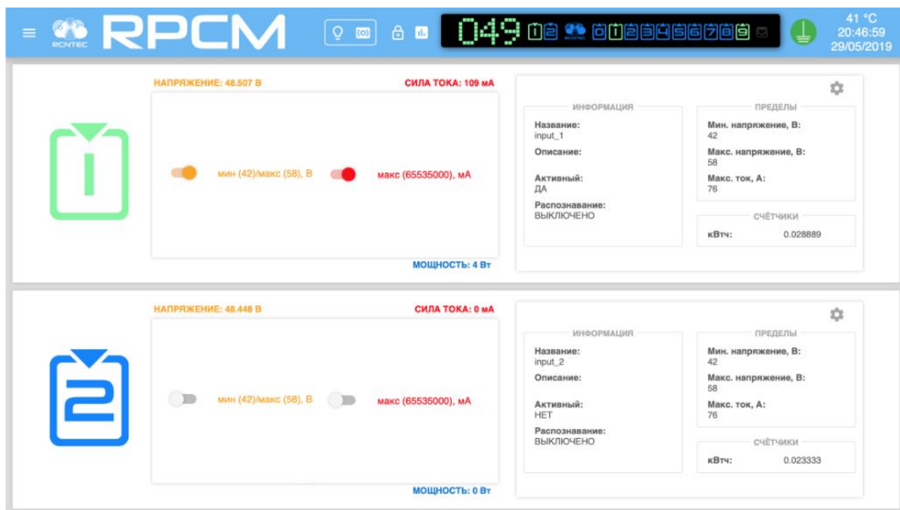
Рисунок 4.4.10. Установка визуализации пределов на примере RPCM DC ATS 76A. Для первого ввода включён режим демонстрации.
